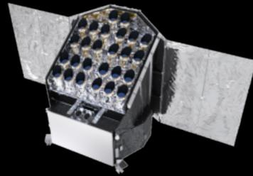
La carga útil (PLM), es el multi-telescopio que incluye las cámaras, el banco óptico y el sistema de procesamiento de datos (DPS). DPS está compuesto las unidades electrónicas (ICU, FEU y MEU) y el software ejecutándose en sus procesadores.
